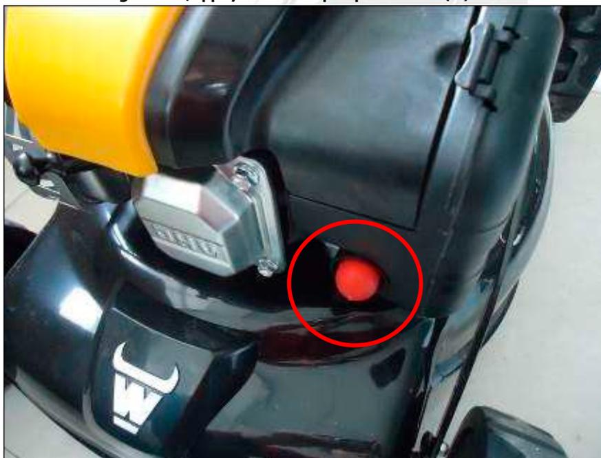
Remarque: Avec un moteur chaud (jusqu'à 1 minute après l'arrêt du moteur), le pompage n'est généralement pas nécessaire pour redémarrer le moteur.
