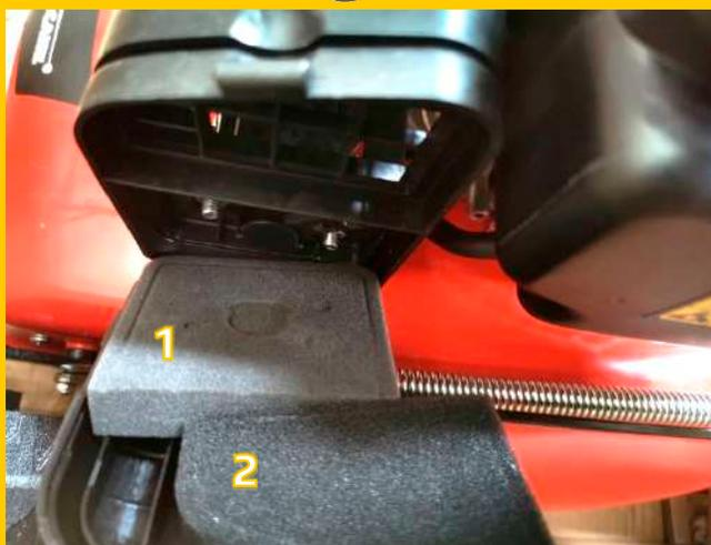
Nettoyez les éléments filtrants 1 et 2 dans une solution détergente. Laissez les éléments filtrants sécher à l'air pendant au moins 12 heures.
